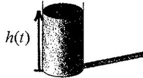
Aus einem zylindrischen Gefäss mit einem horizontalen Ausflussrohr fliesst Wasser. Die experimentelle Kurve ist durch die Messpunkte (vgl. unten) gegeben. Die theoretische Kurve habe immer den gleichen Startpunkt  $P_0$  wie die experimentelle Kurve. Die theoretische Kurve wird durch folgende Gleichung beschrieben:  $h(t) = h_0 e^{-kt}$ .
