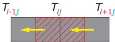
Von rechts hinein:  $\Delta Q_{\text{in}} = \lambda \Delta t A (T_{i+1j} - T_{ij}) \frac{1}{\Delta x}$
