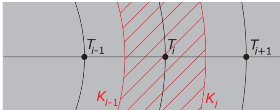
Fluss durch  $K_{i-1}$  nach innen:  $\lambda 4\pi \left(i - \frac{1}{2}\right)^2 \Delta x^2 (T_i - T_{i-1}) \frac{1}{\Delta x}$
